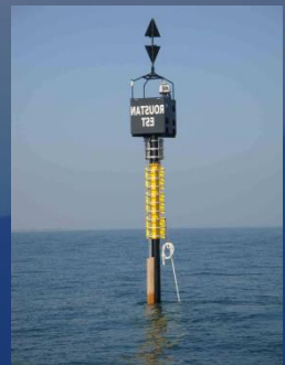
Une balise équipée de capteurs à l'embouchure
