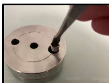
Outil support pour capsule Dépôt de capsule
