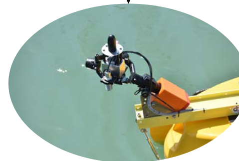
Système Cyclopée : antenne\récepteur GNSS antenna/receiver et un altimètre
